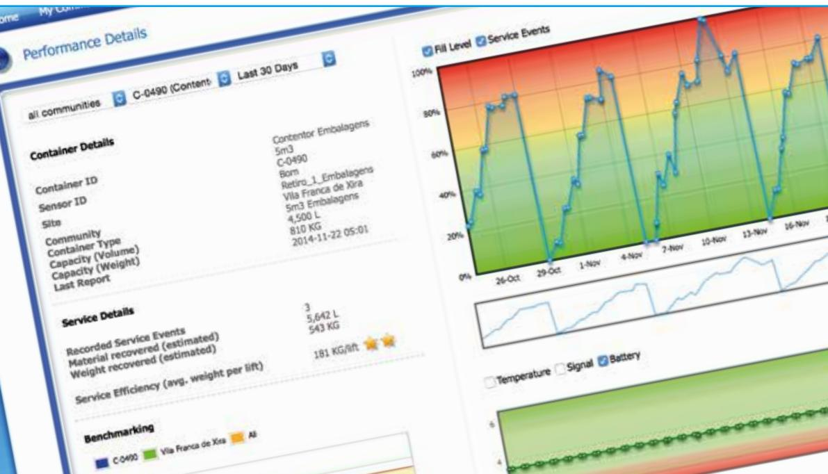
Le système de gestion du niveau de remplissage et de planification d'itinéraire SOTKIS utilise un capteur à ultrasons et un portail Web pour fournir des informations sur l'état de remplissage de chaque conteneur équipé du système.
